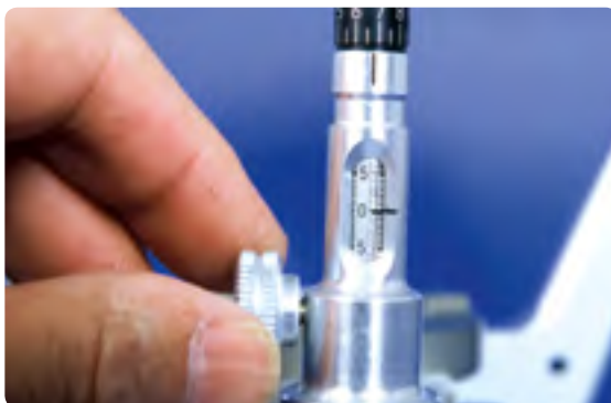
Abb. 22 Die Fixierschraube wird geschlossen...
