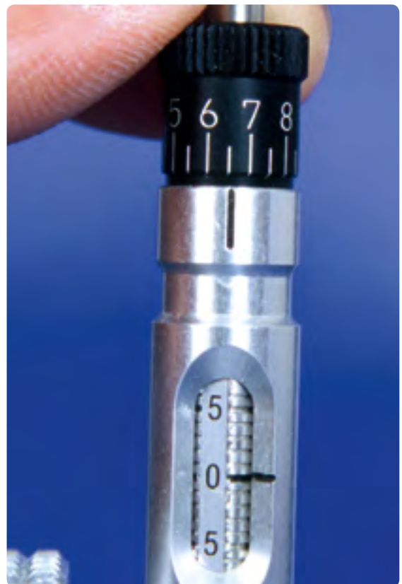
Abb. 23 ...und die skalierte Rändelschraube bis zum unteren Anschlag gedreht. Der erhaltene Wert ergibt den Basiswert
