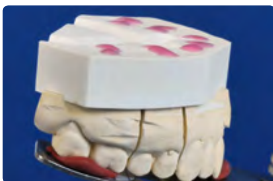
Abb. 13 Das Oberkiefermodell: gepinnt und gesägt in einzelne Compartments ...
