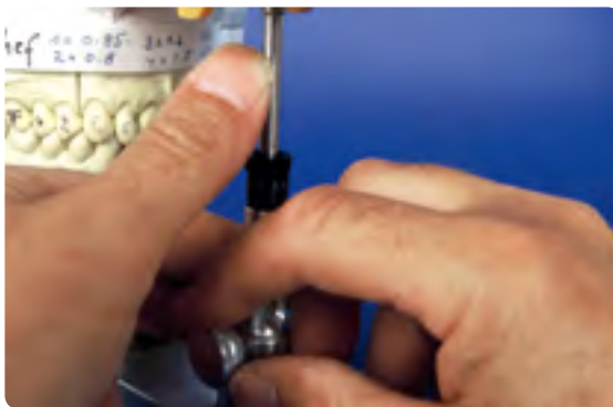
Abb. 21 Verriegelung dieser Höhe mit der Fixierschraube
