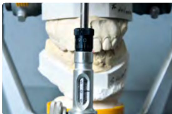
Abb. 16 Den Schlüssel zur Modellanalyse stellt der in 1/100 mm skalierte Stützstift (SAM) dar, mit dessen Hilfe die Höhe der Compartments gemessen werden kann. Alle Modelle werden in 0,0-Stellung des Stützstiftes einartikuliert
